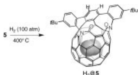
Schema 2. Einbau von molekularem Wasserstoff in das Innere des ringgeöffneten Fulleren 5 .
